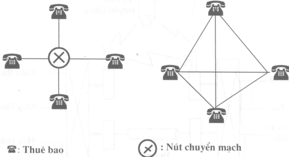
Hình 1.4: Cấu trúc mạng điện thoại có và không có thiết bị chuyển mạch
