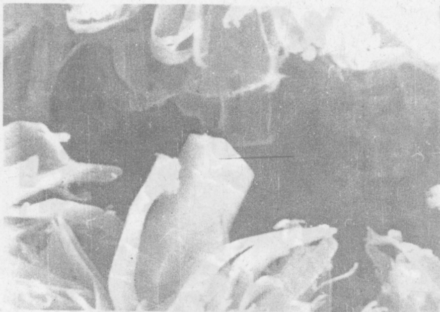
3. Khoáng Tobermorit hình lá xung quanh tinh thể C_3AH_6 .
