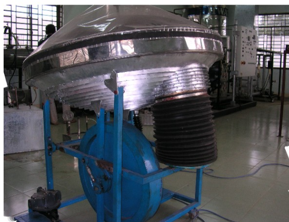
Hình 5.30. Bơm nước Stirling dùng NLMT
