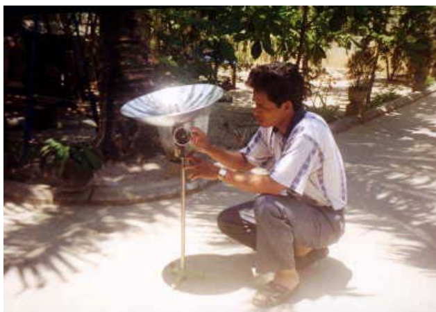
Hình 3.7 Động cơ Stirling dùng NNLMT
