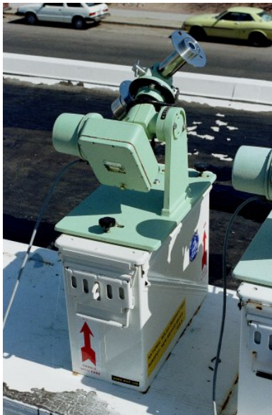
Trực xạ kế - Pyrheliometer
