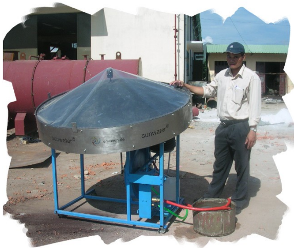
Hình 3.8. Bơm nước chạy bằng NLMT
