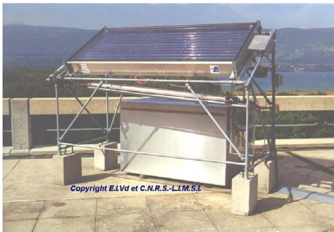
Hình 3.11 Hệ thống lạnh hấp thụ dùng NLMT
