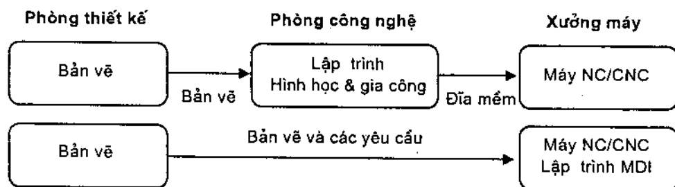
Hình 4.2. Phương pháp lập trình trực tiếp
