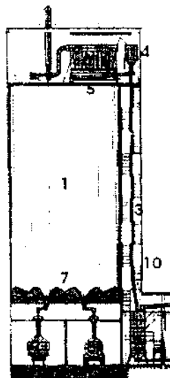
Hình 2.62: Silo chứa xi măng portland
