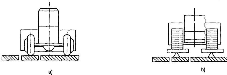
Hình 6: Cân ô tô hoặc lực kế chịu nén - Cân tại một phía a) Máy bánh lốp; b) Máy bánh xích.
