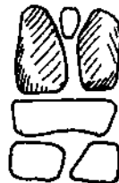
Hình 3- 120 : Xây đá theo kiểu dựng bia
