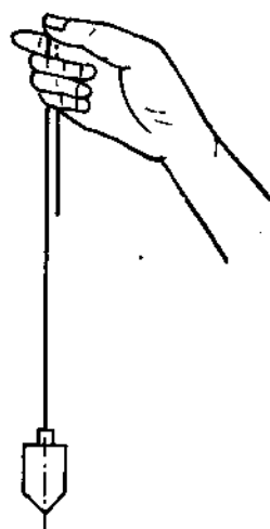
Hình 9 : Cách cầm dây dọi
