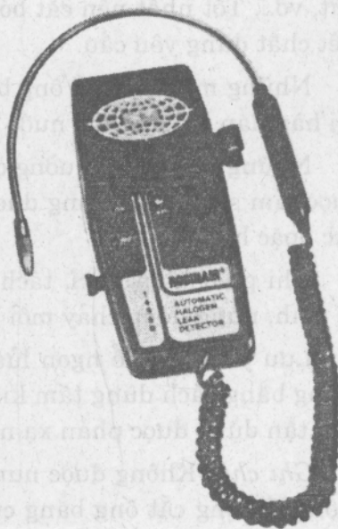
Hình 14.11. Máy dò ga điện tử Robinair 14950 chạy bằng pin
