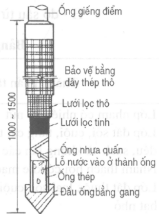
Hình 10.4. Cấu tạo ống lọc nước
