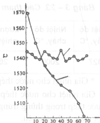
Hình 3-121. Gia nhiệt cảm ứng mặt bên thùng trung gian. Hình 3-122. Thay đổi nhiệt độ gia nhiệt và không gia nhiệt nước thép trong thùng trung gian.
