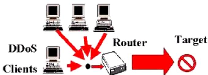
client kết nối đến các DDoS server, sau đó đồng loạt ra lệnh cho các DDoS server này tiến hành tấn công DDoS đến hệ thống nạn nhân.
