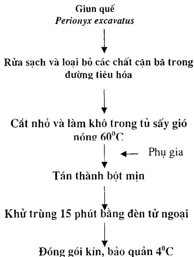
Hình 2.1: Quy trình sản xuất bột giun làm thuốc
