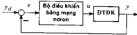
Hình 8 : Bộ điều khiển thể hiện bằng mạng nơron trong cấu trúc điều khiển theo vòng kín.
