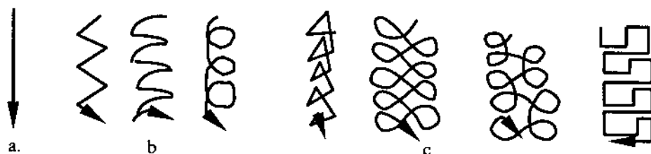
Hình 7.36. Các hình thức dao động của que hàn
