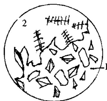
Hình 65. Một góc của mảnh gạch đinat (phần bên dưới hình) rơi vào thủy tinh (1) và nền thủy tinh (2).
