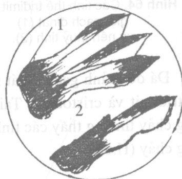
Hình 63. Các tinh thể cristobalit dạng bản mỏng (1) và nền thủy tinh (2).
