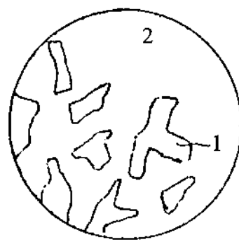
Hình 67. Tinh thể nephelin (1) trên bề mặt gạch tiếp xúc với thủy tinh (2).
