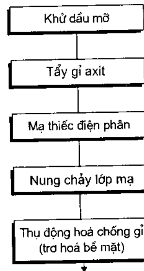
Hình 5.12. Sơ đồ công nghệ mạ thiếc điện phân.
