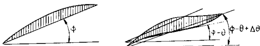
Hình 12.17. Thay đổi mép bước do biến dạng tiết diện cánh
