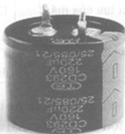
Hình 2.2: Tụ điện có chứa PCBs
