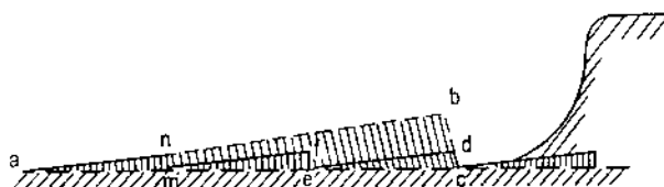
Hình 10-10a. Đào sót và biện pháp giảm bớt đào sót
