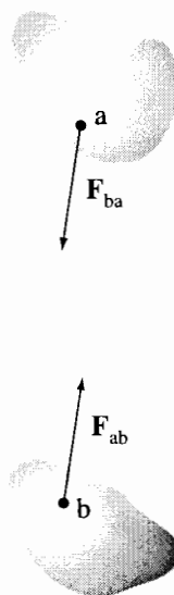
Hình 4-6. Định luật thứ ba của Newton. Các vật a và b tác dụng các lực lên nhau. Theo định luật thứ ba của Newton, các lực này bằng nhau và ngược hướng : F_{ab} = -F_{ba} . Trên hình vẽ các lực này được chỉ ra như các lực hút : F_{ab} hướng vào a, F_{ba} hướng vào b.
