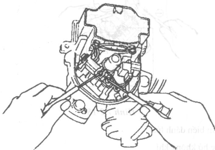
Hình 7.2-20: Đo điện trở cuộn cảm biến đánh lửa
