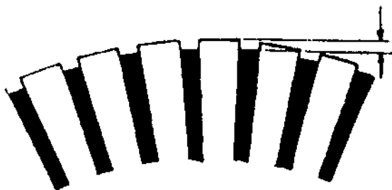
Hình 7.3-9: Kiểm tra độ sâu của rãnh giữa các phiến góp
