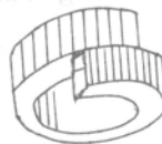
Hình 3-42. Đo chuyển vòng dây làm chiều cao dây quấn tăng thêm 1 vòng
