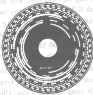
Hình 6.4. Đĩa mã hóa tuyệt đối.
