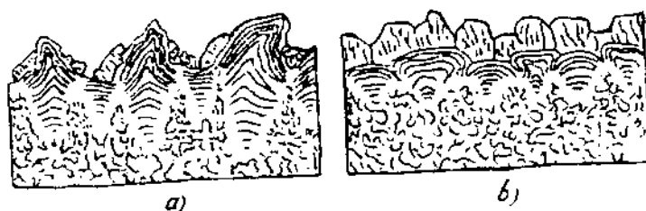
Hình 3.9A. Mô hình cấu trúc của các lớp bề mặt khi mòn Fretting a) tróc , b) oxy hoá động
