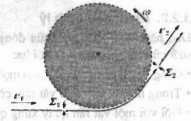
H.17. Hệ mở \mathcal{S} được cấu tạo bởi tuabin và nước nằm giữa \Sigma_1 và \Sigma_2 .
