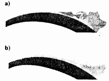
H.53. Trong khi lớp giới hạn rời (b) móc vào profin, thì lớp giới hạn thành lớp lại rời khỏi đó (a).
