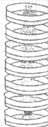
Hình 5.24b - Mẫu sàng phân tích cấp hạt của tầng trữ nước
