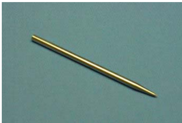
H10. Scratch pin ( Que thử chịu mài mòn )
