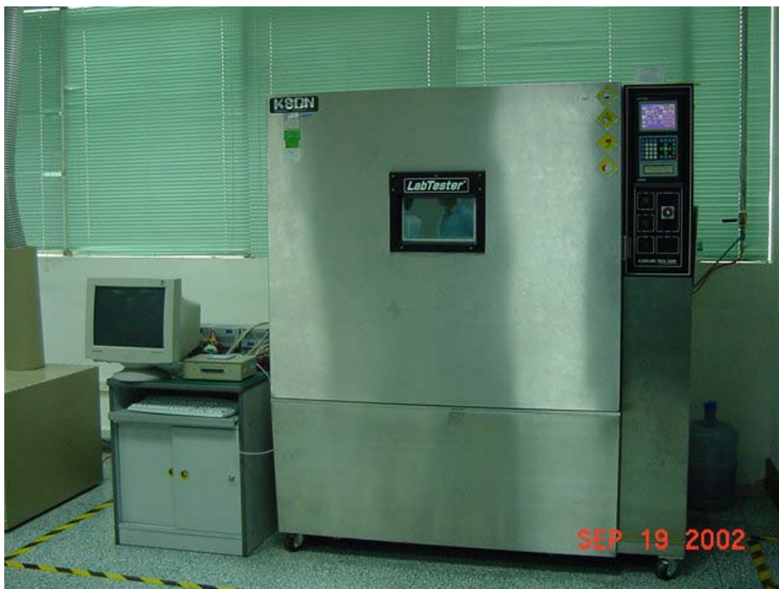
Thiết bị thử khả năng chịu thay đổi nhiệt độ và nóng ẩm
