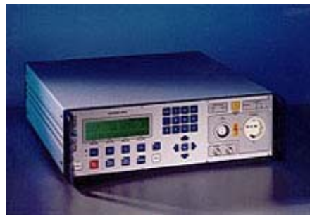
H.31 Máy phát Surge
