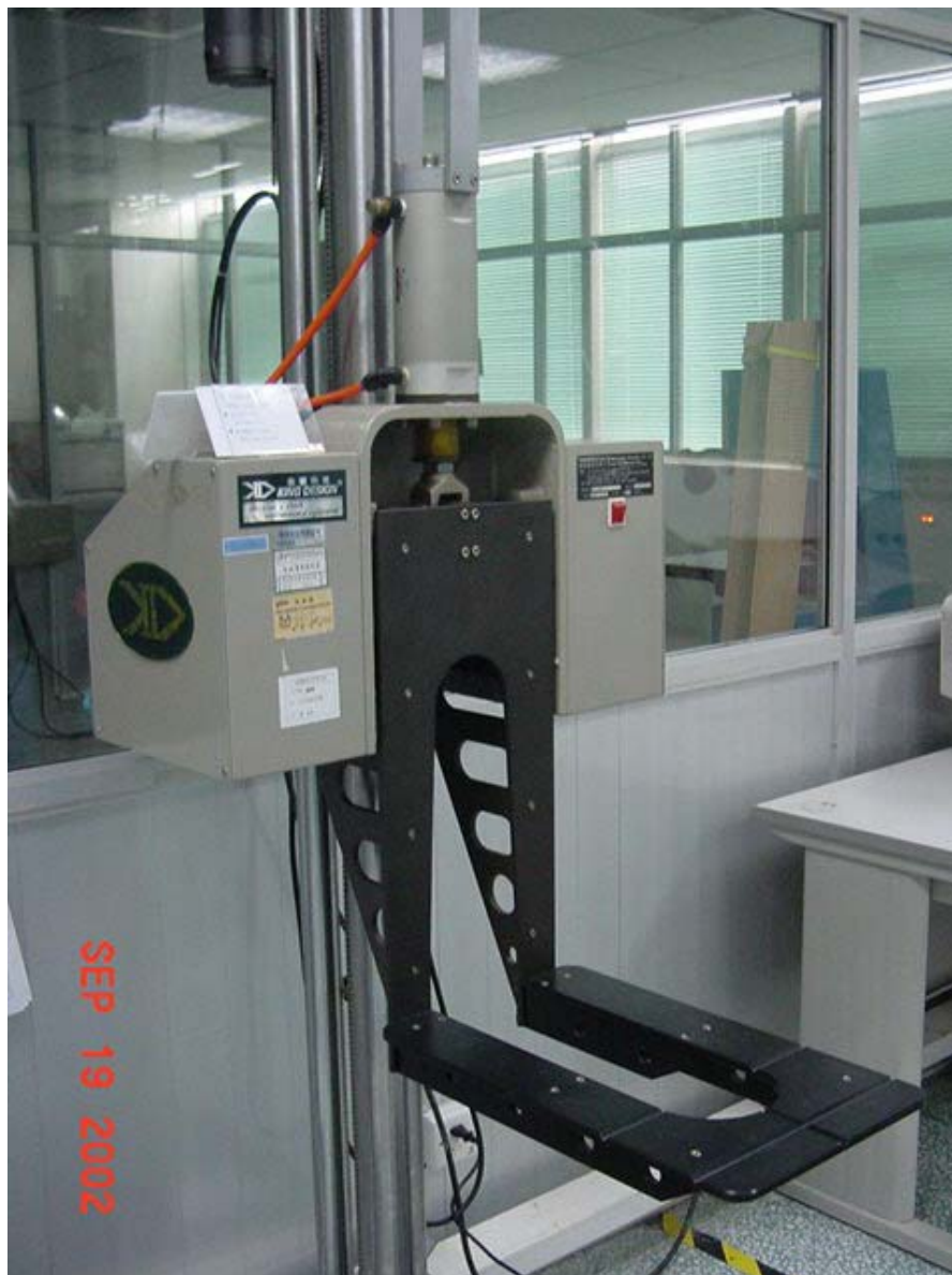
Thiết bị thử xuất xưởng khả năng chịu va đập của máy tính
