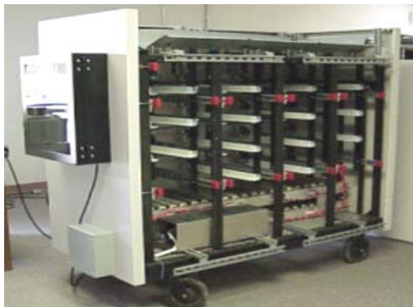
Xe thử lão hóa và chở SPS vào chamber
