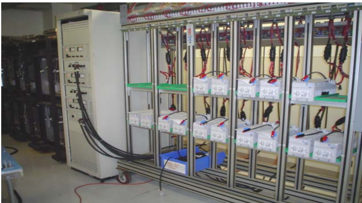
Xe đẩy và tủ điều khiển thử lão hóa trong chamber
