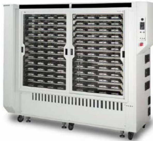
(Hình ảnh là Chamber Pegasus 104B của FlexStar Technology để thử burn-in các loại ổ đĩa)
