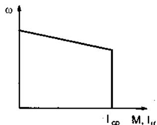
Hình 4 - 15. Dạng đặc tính của hệ điều chỉnh độc lập các tọa độ kiểu nối tiếp
