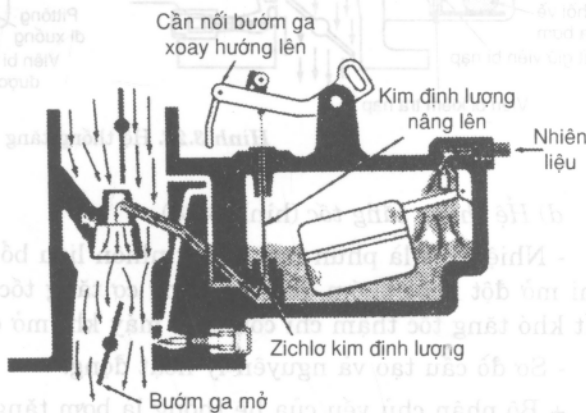
Hình 3.26. Hệ thống toàn tải điều khiển cơ khí.
