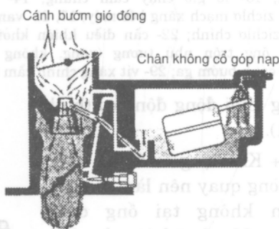
Hình 3.29. Hoạt động của các vòi phun khi đóng bướm gió để khởi động.
