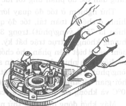
Hình 14.14. Kiểm tra chập mạch nắp máy phát điện bằng dụng cụ 533.
