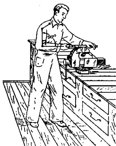
Hình 1.3. Bố trí bục công tác khi giũa
