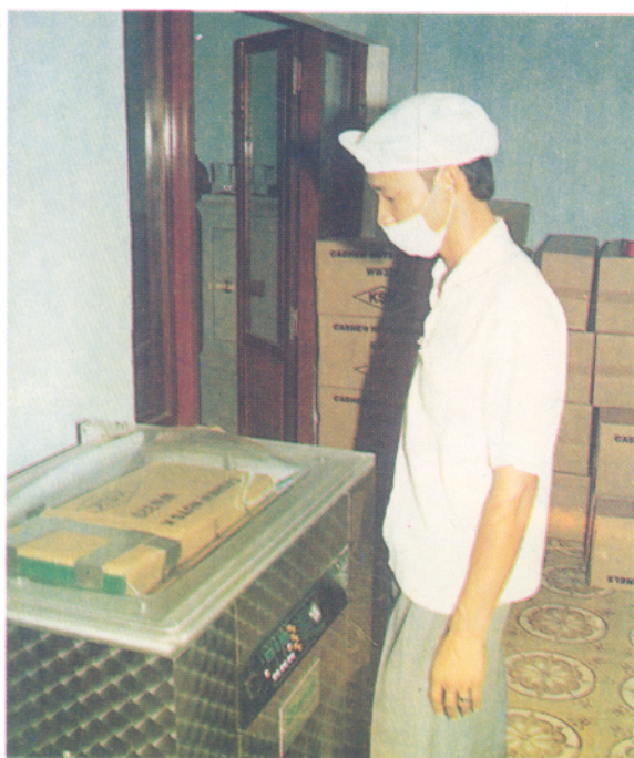
◀ Ảnh 9 : Thiết bị đóng gói nhân điều trong bao bì chất dẻo của hãng Oltremare (Ý) tại Công ty Donafoods
