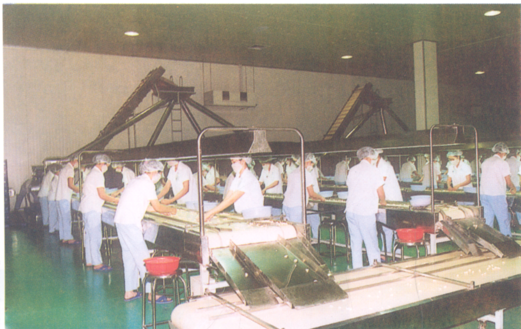
▲ Ảnh 5 : Phân cấp hạng sản phẩm nhân điều trên băng chuyền ở công ty Donafoods Đồng Nai.
