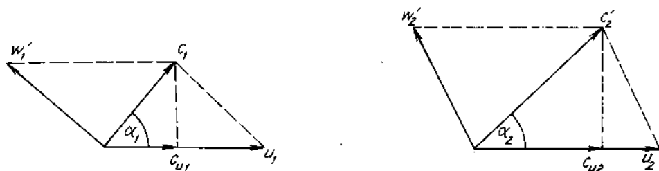
Hình 3.19. Biểu diễn vận tốc chất lỏng
