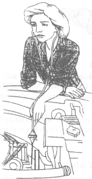
Hình 103: Dùng ống nghe để dò tìm vị trí phát ra tiếng khua trong động cơ.
