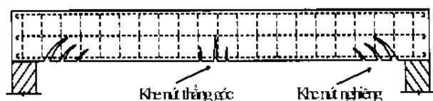
Hình 7-4: Các dạng khe nứt trong dầm đơn
